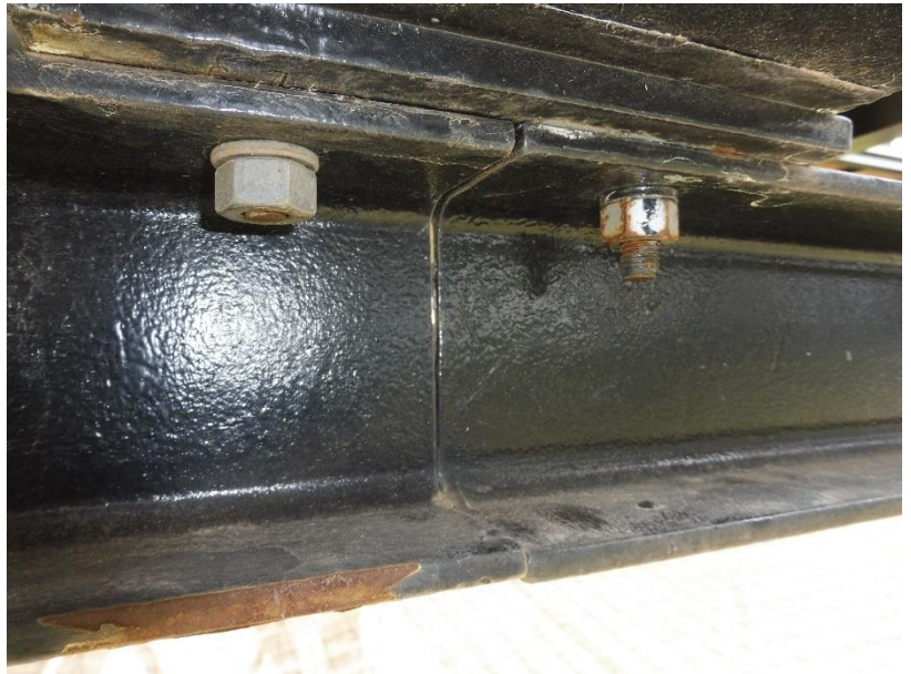
Photo 139 Frottement du profilé et corrosion / Chariot
